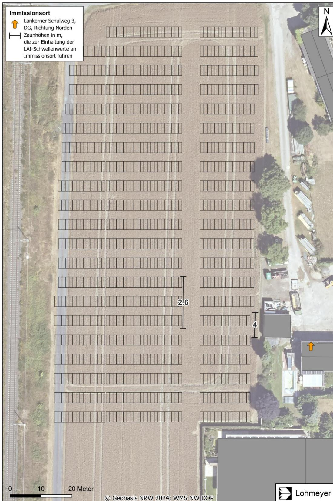
**Abb. 5.5:** Darstellung der Zaunhöhen, die am Immissionsort Lankerner Schulweg 3 im Dachgeschoss Richtung Norden zur Einhaltung des LAI-Schwellenwerts führen
