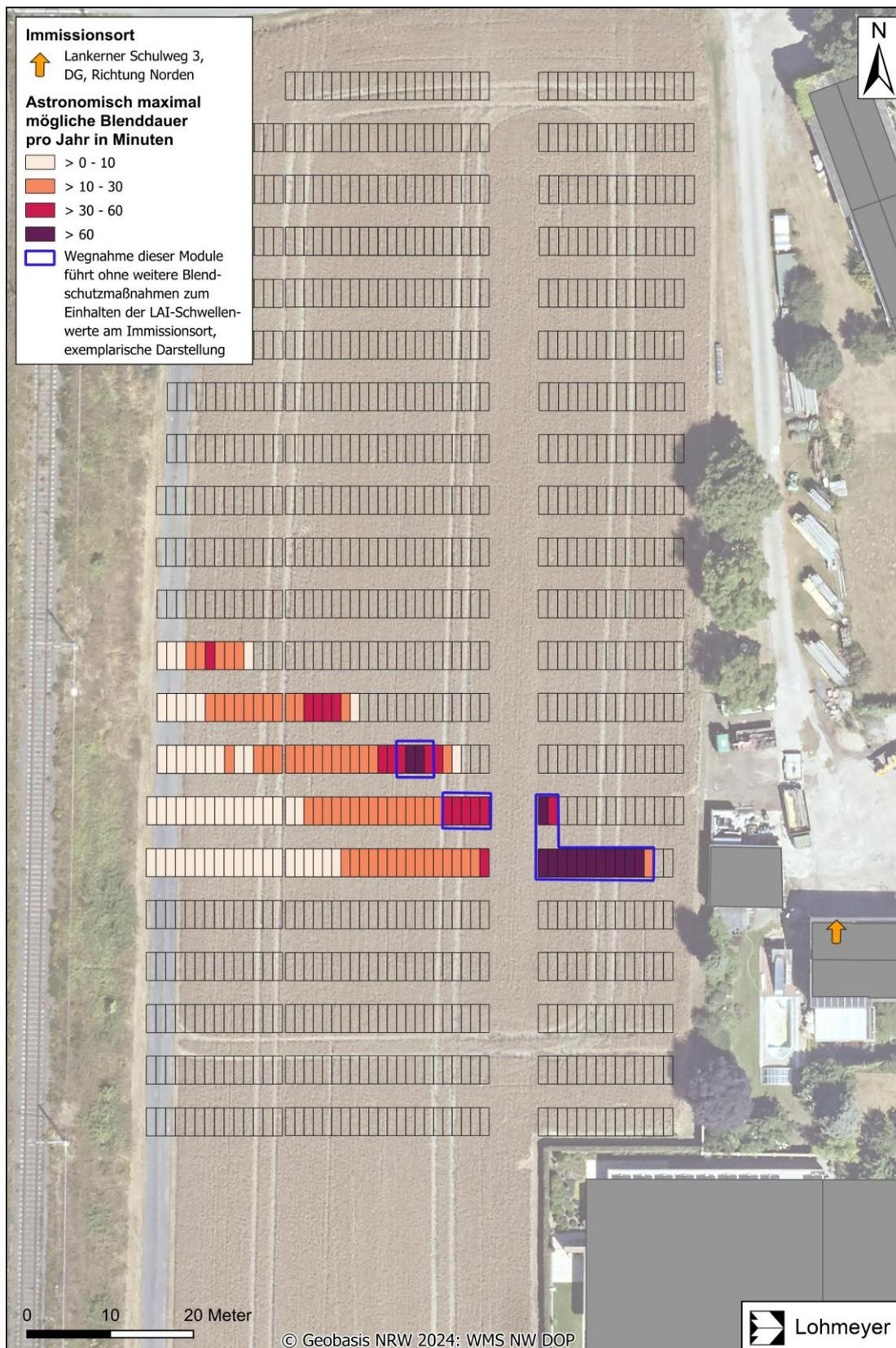
**Abb. 5.3:** Darstellung der Module, die am Immissionsort Lankerner Schulweg 3 im Dachgeschoss Richtung Norden zu Blendungen führen können, sowie Vorschlag für eine Modulwegnahme zur Einhaltung des LAI-Schwellenwerts
